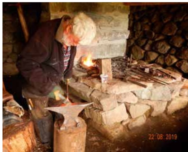
Smia vil bli brukt av handverkarane til å laga dør- og vindubeslag og anna dei treng til restaureringsarbeidet. Ted Johnny Taraldsen er alt i gang.
