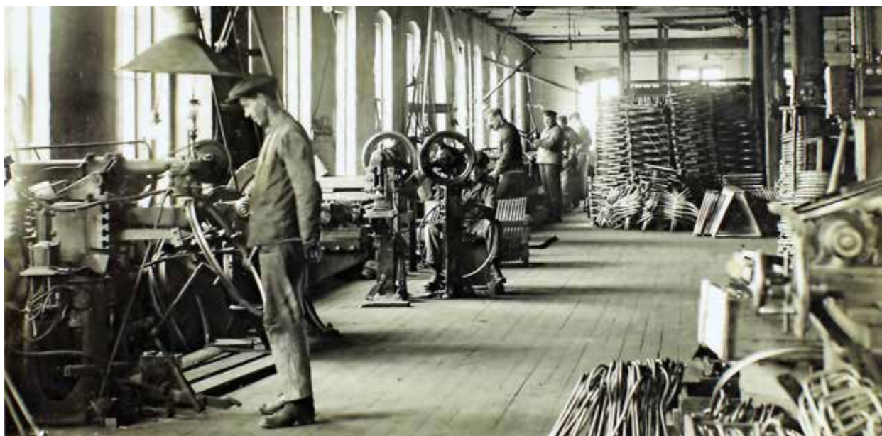
Sykkelfproduksjon i fabrikken i Solaveien: ramme- og felgsveising. Foto: ukjent, *Jærmuseet.
