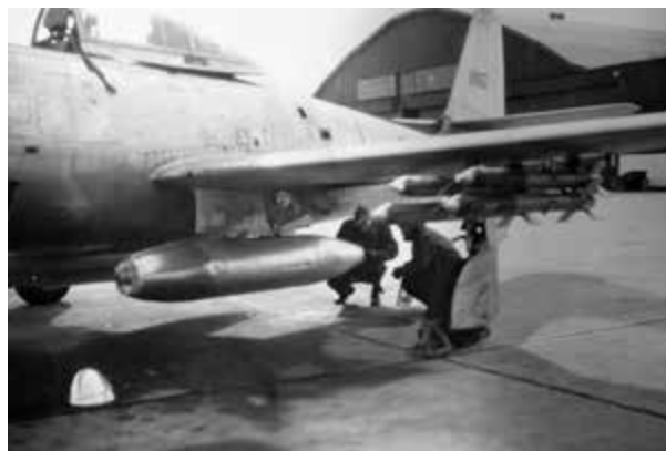
Her inspiseres beholderen med napalm under vingen på en F-84G Thunderjet på Sola.
