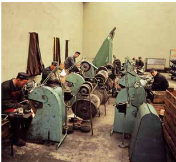
På foto t.v sitter arbeiderne ved slipemaskiner og sliper deler før lakkering og fornikling i sliperiet, mens foto t.h. viser sveising av felger. Begge deler foregikk i sykkelfabrikken Nr. 11 i Elvegata i 1967. Foto: Knudsens fotosenter *Fotosamling Jonas Øglænd, Jærmuseet.
