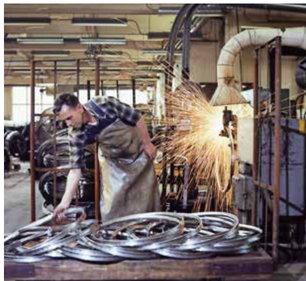
På foto t.v sitter arbeiderne ved slipemaskiner og sliper deler før lakkering og fornikling i sliperiet, mens foto t.h. viser sveising av felger. Begge deler foregikk i sykkelfabrikken Nr. 11 i Elvegata i 1967. Foto: Knudsens fotosenter *Fotosamling Jonas Øglænd, Jærmuseet.
