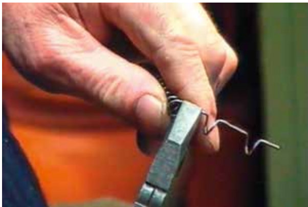
Fjõra må strekkast såpass at ringane får stødige og lange nok «labbar».
