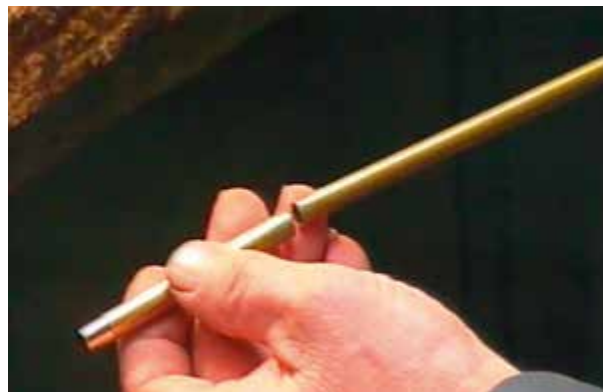
Holkane blir prøvd, vanlegvis må det både pussast og målast nokre omgangar før arbeidet blir godkjent.
