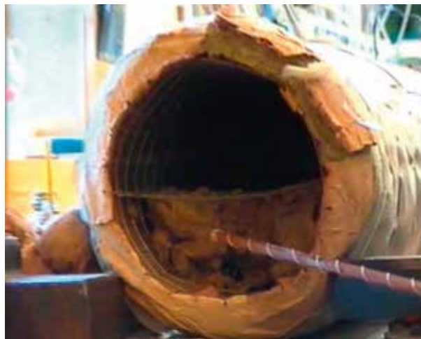
Varmekanal sett frå enden, nettingrull som er isolera med steinull, horisontalt er varmekanalen delt i to. Emna blir lagt øvst og opninga dekt med ein dott steinull.
