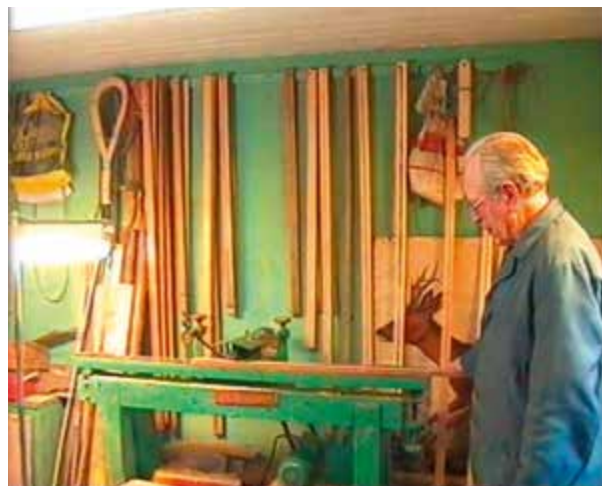
Malane som heng på veggen er mange og variera, rett mal til rett stang. I tillegg må malane skiftast etter kvart som dei trekanta spilene blir høvla ned.
