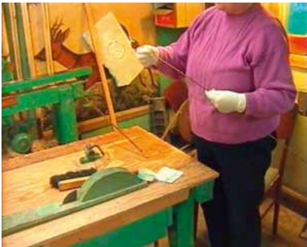
Magnhild nyttar ikkje pensel når ho lakkerar den ferdige stanga. Ho trekkjer på seg tynne hanskar og stryk oljelakken ut med fingrane.
