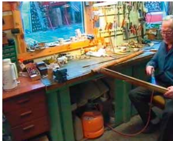
Garman nyttar gassbrennar til å tørka emnet av tonkin før det vidare arbeid. Frå før har emnet lege til tørk i fleire månadar i romtemperatur.
