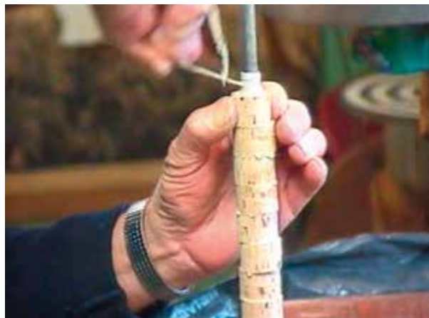
Garman trer korkbetane på ein olja aksling. I enden på kvar av betane er dei smurde inn med lim.
