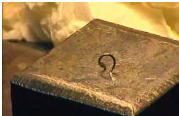
Ring med ferdige «labbar» klar for montering.
