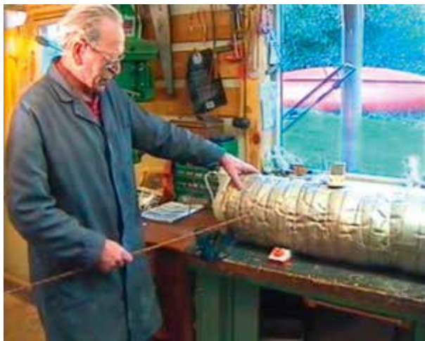
Garman forklarar prinsippet med varmekanalen eller herdeovnen. Fleire termostatar og stoppeklokke er viktig for at resultatet skal bli optimalt.
