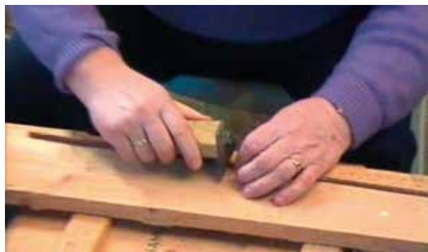
Etter at surringane er teke vekk legg Magnhild det ferdig lima emnet flatt på eit stabilt underlag og skrapar varsamt bort limet som har blitt pressa ut under limeprosessen.
