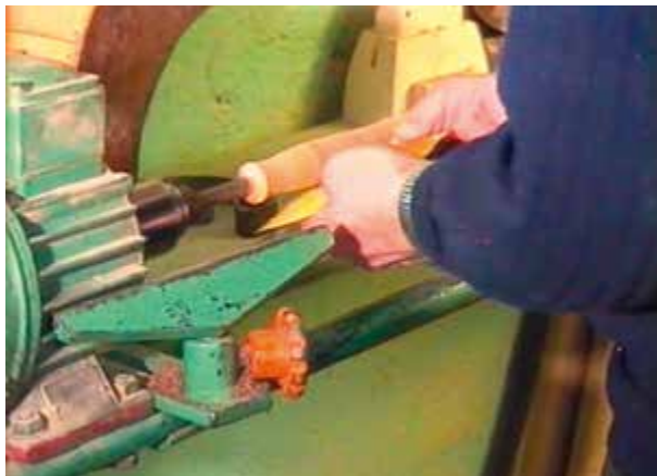
Finpussen tek han med smergelpapir, grovt i starten og fint til slutt. Handtaket blir ikkje sett inn med olje.
