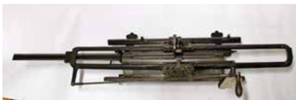
Maskinen, merket J. F. Grosser, med den spesielle slede-utformingen. Hele det lange ovale stykket beveger seg når det strikkes. Foto: Jærmuseet.
