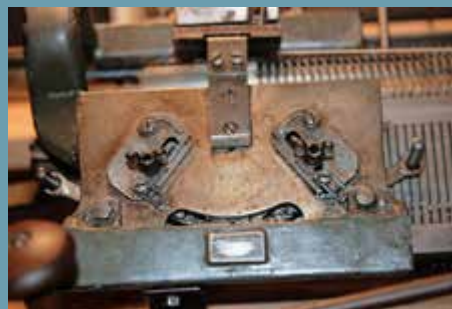
Sledeinnstilling ved ribbestrikk. Textima. Foto: Jærmuseet.
