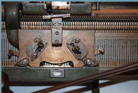
Sledeinnstilling ved patentstrikk. Textima. Foto: Jærmuseet.
