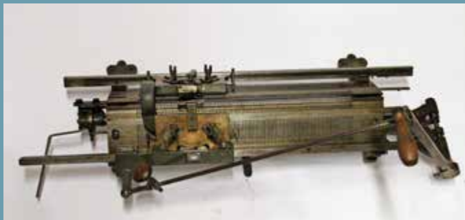
Flatstrikkemaskin av den gamle støpejernstypen som ble brukt av spøtakonene. Med nødvendig utstyr som garnstativ, lodd, kammer, skinnetrekkerhake og maskehake. Dekknåler var også nødvendig, men slike finnes ikke i Jærmuseets samling. Foto: Jærmuseet.
