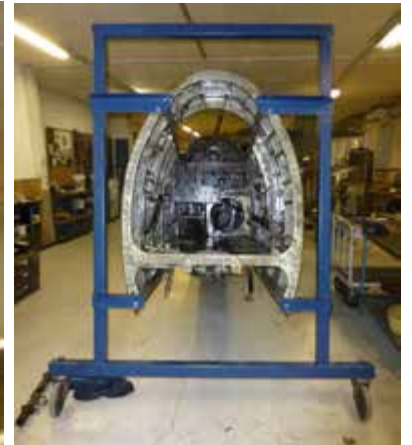
Bilde 8: haleseksjonen ble montert på to rammer med hjul. Foto: Eirik Aarebrot, Jærmuseet.
