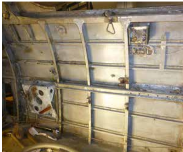
Bilde 11: parti fra bakre cockpit etter at det er rensset videre med «Scotchbrite» og vasket med whitesprit. Foto: Eirik Aarebrot, Jærmuseet.
