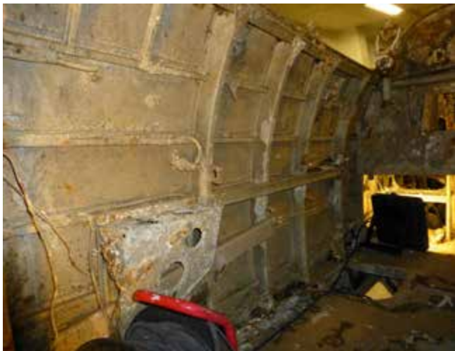
Bilde 10: bakre cockpit før rensing og konservering. Foto: Eirik Aarebrot, Jærmuseet.
