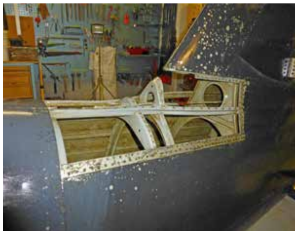
Bilde 4: manglende plate ved haleroten. Foto: Eirik Aarebrot, Jærmuseet.
