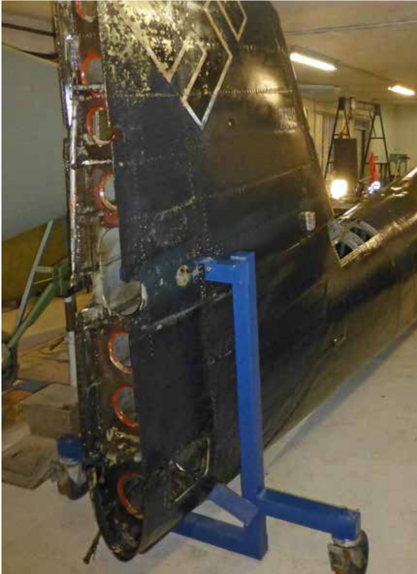
Bilde 8: haleseksjonen ble montert på to rammer med hjul. Foto: Eirik Aarebrot, Jærmuseet.
