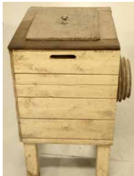
Trekasse med metall innside, lok av tre, Hoover-rotor i sida og hjul til reimoverføring til motor. Dette var ein vanleg modell på Jæren. Gabriel f. 1936 hugsar at han var med og henta ei slik maskin rundt 1950. Det var kanskje på Ånestad, Varhaug. Foto: Jærmuseet.
