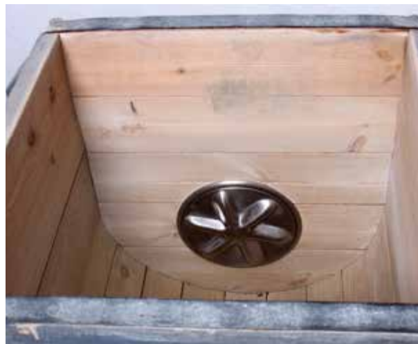
Vaskemaskin i tre med «Hoover-rotor». Rotoren var driven av ein ekstern eller eigen motor. Han gjekk berre ein veg slik at det kunne vere eit problem at tøyet sette seg fast mellom rotoren og kassa. Det kunne bli øydelagt. Foto: Jærmuseet.
