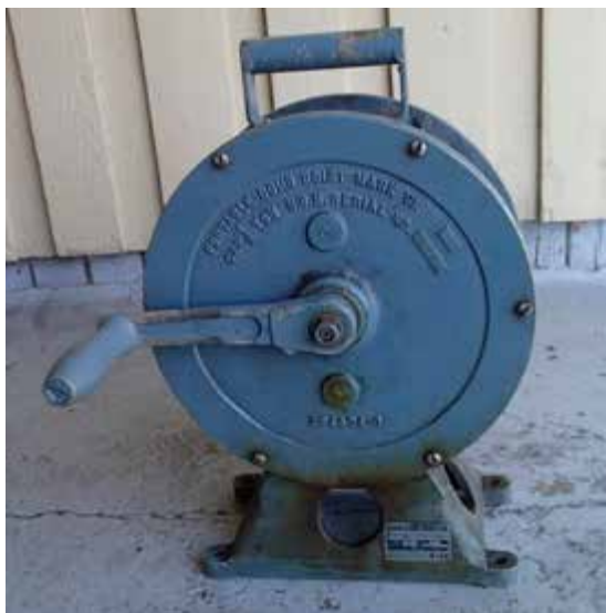
Bombeheisen ble brukt til å løfte bomber under vingene til Catalina-flyene. Foto: Jærmuseet.
