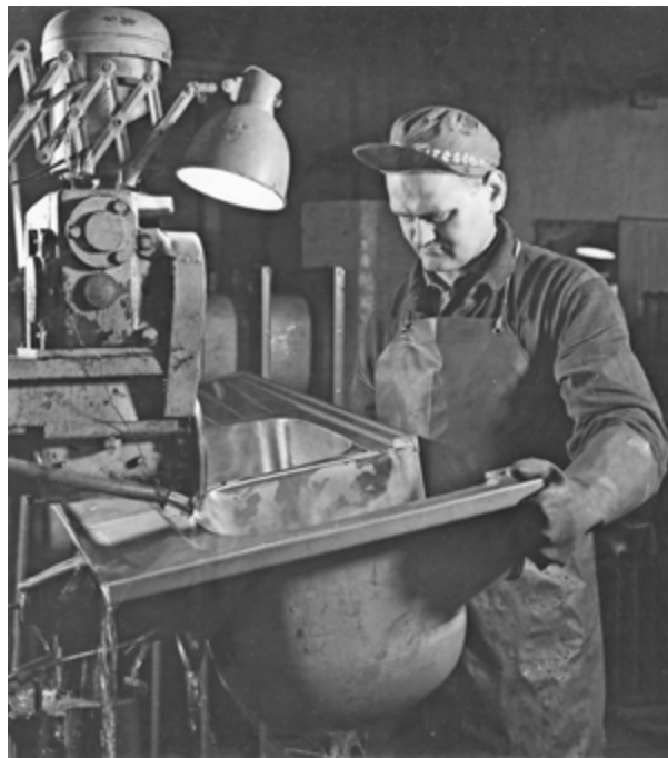
Polaris var tidlig i gang med produksjon av benkebeslag og utslagsvasker i rustfritt stål. Foto: Fotosamling Polaris A/S, Jærmuseet.
