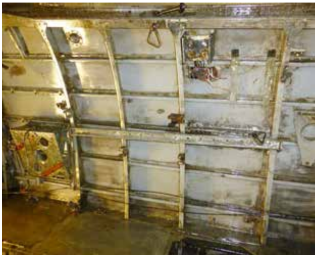
Bilde 12: samme parti fra bakre cockpit etter at det er behandlet med lanolin. Foto: Eirik Aarebrot, Jærmuseet.
