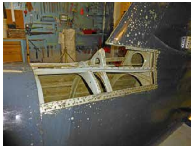
Bilde 4: manglende plate ved haleroten. Foto: Eirik Aarebrot, Jærmuseet.
