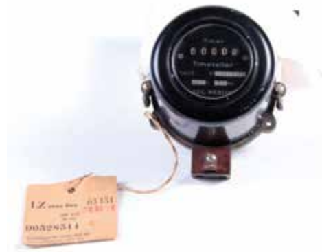
Timeteller fra Jærens Elektrisitetsverk. Den har trolig vært montert på generator eller transformator i kraftstasjonen for måling av produksjonstid.
