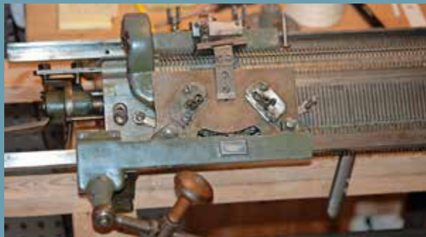
Nærbilde av slede, nåleseng og spaker på Textima maskinen. Foto: Jærmuseet.
