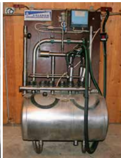
I senere år ble kyrne melket direkte i fjøset og melken ført gjennom et rørmelkeanlegg til en tank. Her ser vi et rørmelkeanlegg fra Erlands maskinfabrikk på Bryne.
