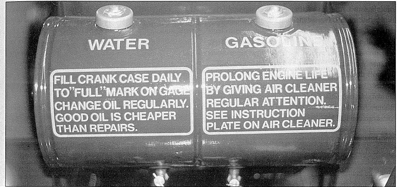
Bokstavane på skjermene blir malte med stødig hand. Teksten på bensintanken/vassstanken blei derimot sette med letraset. Alle lokk til bensin- vass-, parafintank og radiator er og nylaga. Også til denne prosessen måtte det lagast nytt verktøy.
