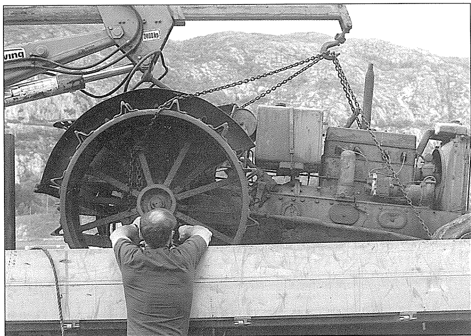
Sverre Skjæveland fekk ta ein del mål på ein tilsvarande traktor hos Sivert Aune i Klæbu. Denne traktoren hadde produktjonsnummer 109015. Her tar Sverre mål av draget.
