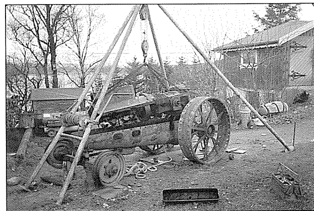
Motorblokka med girkasse blir løyst frå bånnpanna.
