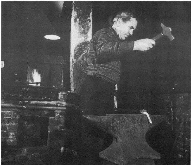
Fig. 8 Igjen kan det lagast ljå i Gjesdal Ljåfabrikk. Arne Sandkleiva, tidlegare Kvernelandssmed, demonstrerer gamle smedkunster. Etter sveisinga blei tjo- det bøygd manuelt på ambolten. Sveiseovnen i bakgrunnen.
