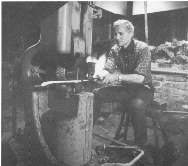
Fig. 9 Mikal Valberg, også han gammel Kvernlandssmed, sinkar ljøen under den mekaniske hammaren. Foto: Kjell Time.
