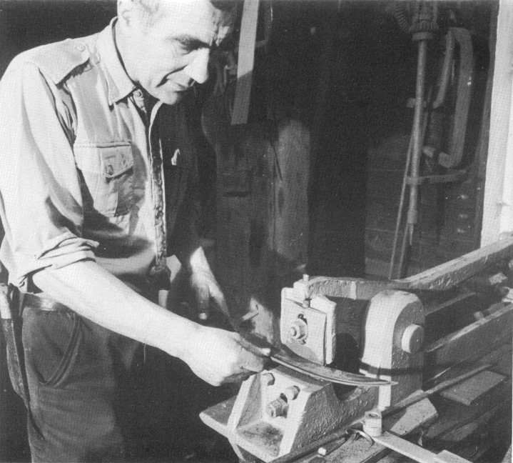
Fig. 10 Sverre Skjæveland syner korleis liden blir "klypt" ved hjelp av ei motorisert saks. Foto: Kjell Time.
