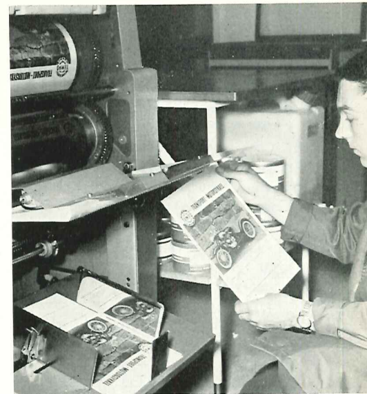
Terje Knutsvik ved offsetmaskinen studerer det ferdige resultat. Øverst i venstre hjørne ser vi trykkeplaten i metall.
