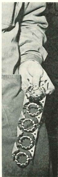
T. b.: Stålplate med utstanste kuleringer — øverst en ferdig ring med kuler innlagt.
