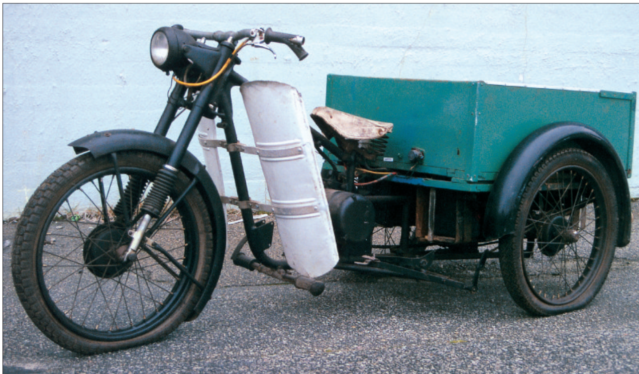
Museet sin Tempo Elektro varesykkkel frå 1942. Denne sykkelen blei først kjøpt av bakeriet Arne Johannesen. I 1945 blei den kjøpt av Brødrene Gundersen som brukte sykkelen dagleg fram til 1983. Det blei produsert 342 av desse syklane. Rammene var utstyrte med feste for bensinmotor, tank og eksosanlegg for seinare overgang til 100 og 125 ccm motor. Maks fart var om lag 27 km i timen, og med fullada batteri kunne den køyra 40–50 km, avhengig av belastning og temperatur. Foto: Per Nygaard
