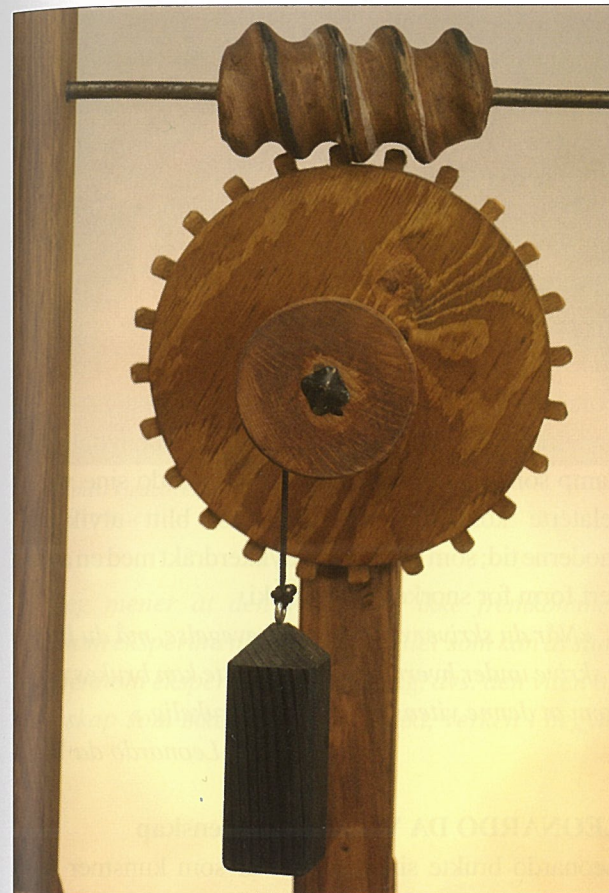
Vekselbevegelse. Leonardo var opptatt av å overføre en bevegelse til en annen type bevegelse. Foto: Dag Magne Søyland.
