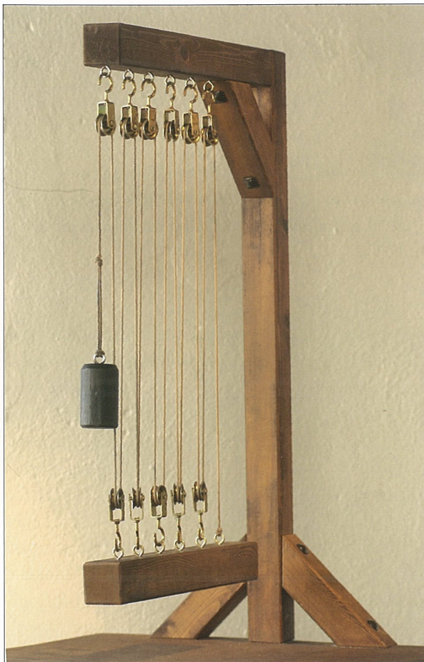
Leonardo studerte hvordan man ved hjelp av taljer kan redusere vekten av en tung gjenstand. Foto: Dag Magne Søyland.
