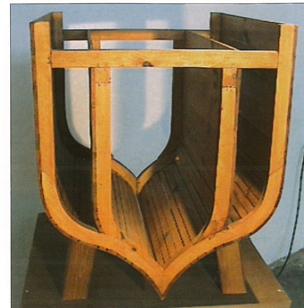
Leonardo tegnet dobbelt skipsskrog ut fra forsvarshensyn. Foto: Dag Magne Søyland.
