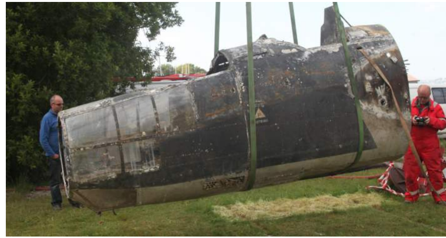
Over. Neseseksjonen . Den ble snudd før den ble lagt i karet
