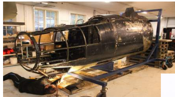
Bildet til venstre viser bakkroppen slik preservert om inntil videre plassert i utstillingen. Bildet i midten og til høyre viser bakkroppen og neseseksjonen under rengjøring.
