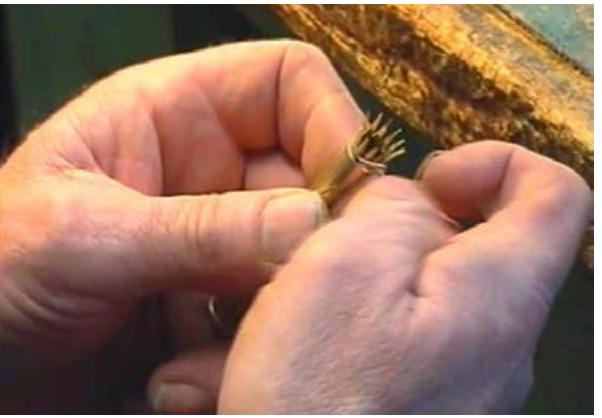
Når holkane er ferdig tilpassa blir dei splitta opp i den enden som skal monterast på stanga, dette gjer Garman for at overgangen mellom metall og tre ikkje skal bli eit svakt punkt på stanga.
