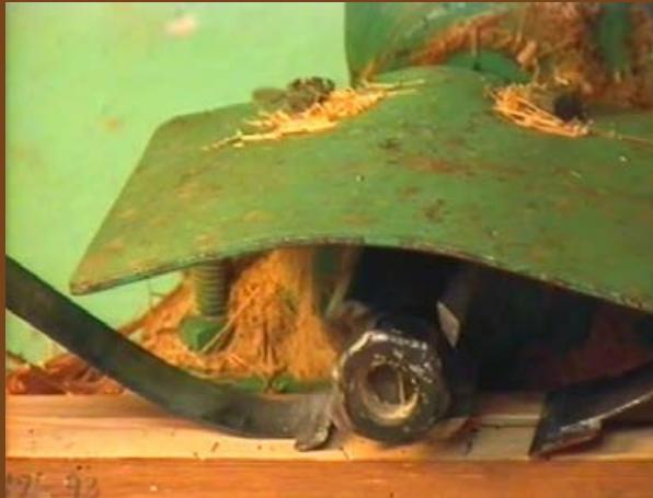
Høvelen som Garman brukte har han tilpassa nøyne, det som er viktig er at der er ei fjør både framfor og bak dei roterande knivane slik at spila ligg stabilt og roleg i malen når den blir høvla.
