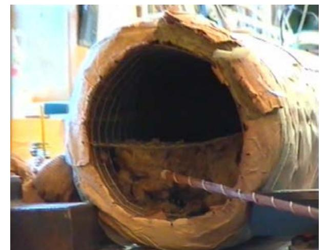
Varmekanalen sett frå enden, nettingrull som er isolera med steinull, horisontalt er varmekanalen delt i to. Emna blir lagt øvst og opninga dekt med ein dott steinull.
